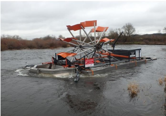
Ce projet d'hydrolienne fluviale permet de générer 75 kwatts par heure ou 250 kwatts en fonction de la force du courant.
